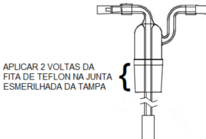
Figura 2 - Aplicação da fita de teflon (veda rosca)
