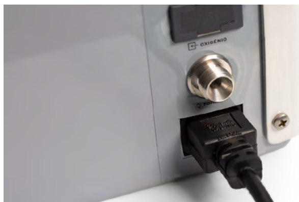
FIGURA 9 - CONEXÃO DO CABO DE FORÇA
