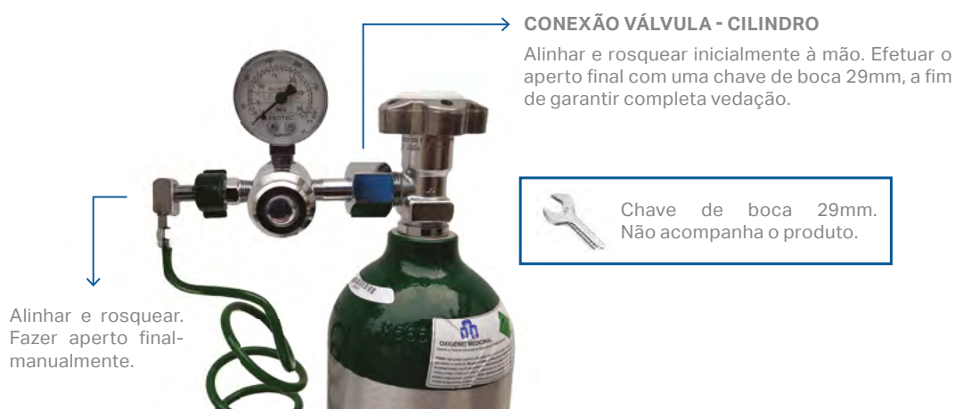
FIGURA 7 - CONEXÃO DA VÁLVULA NO CILINDRO DE OXIGÊNIO
