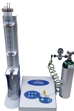
Figura 7 - Montagem do conjunto para ozonização de água
