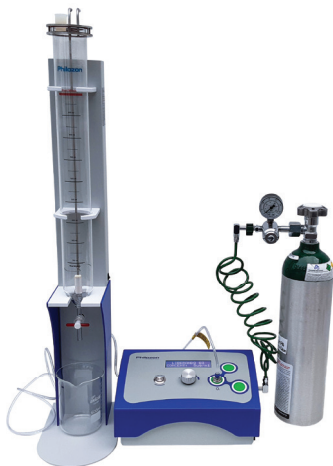
Figura 14 – Montagem do conjunto para ozonização de água
