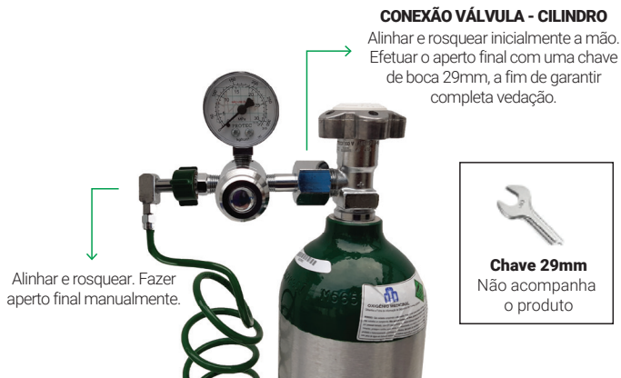
Figura 15 – Conexão válvula-cilindro de O 2
