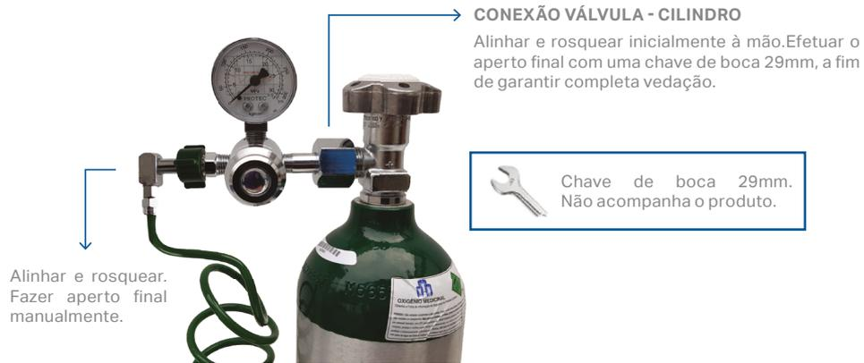
**Figura 8 - Conexão da válvula no cilindro de oxigênio**
