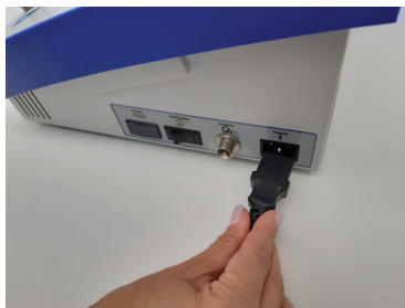
Figura 10 Conexão do cabo de força
