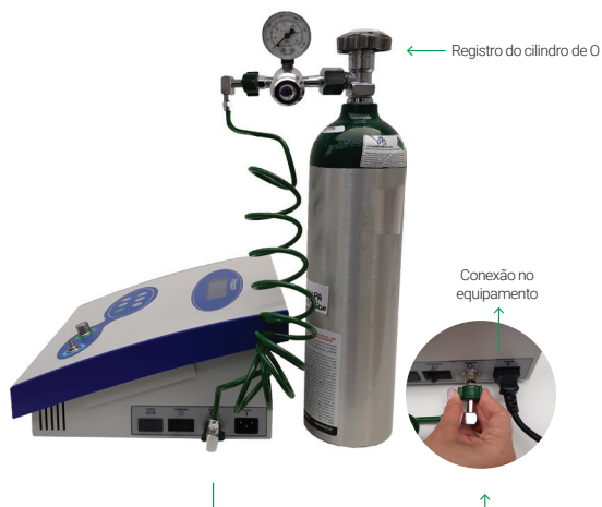
Figura 9 - Montagem do cilindro de Oxigênio e dos registros
