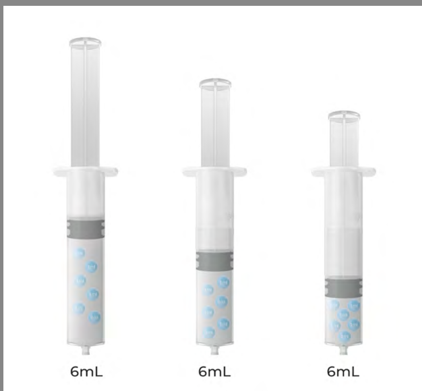
Figura 15 - Gás ocupando o espaço conforme a contrapressão da seringa
