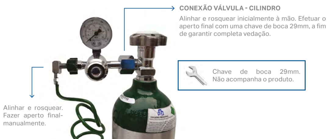
FIGURA 7 - CONEXÃO DA VÁLVULA NO CILINDRO DE OXIGÊNIO
