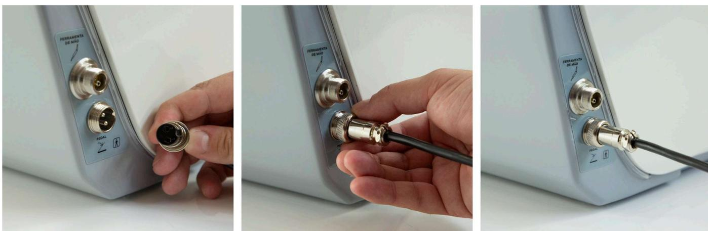
**Figura 28 - Acoplagem da pedaleira no gerador**
