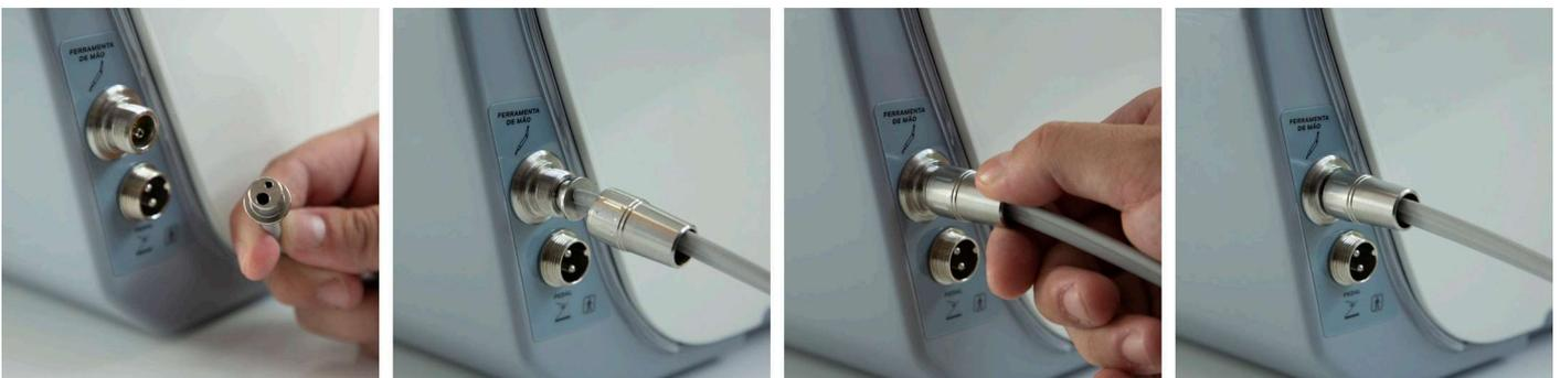
Figura 27 - Acoplagem da peça de mão no gerador
