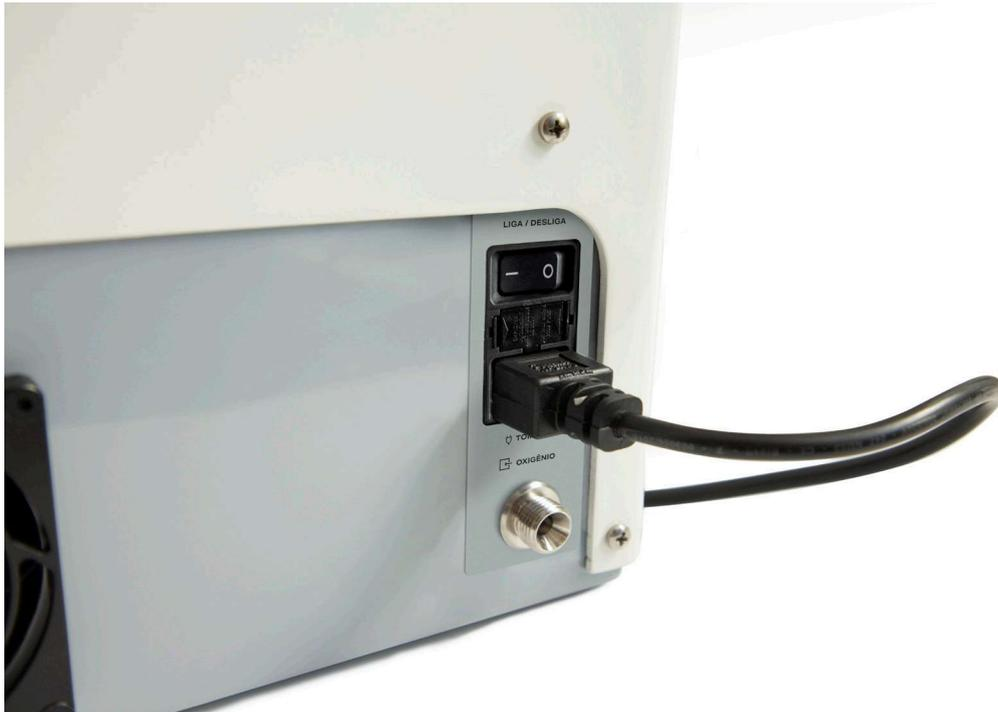
Figura 10 - Conexão do cabo de força
