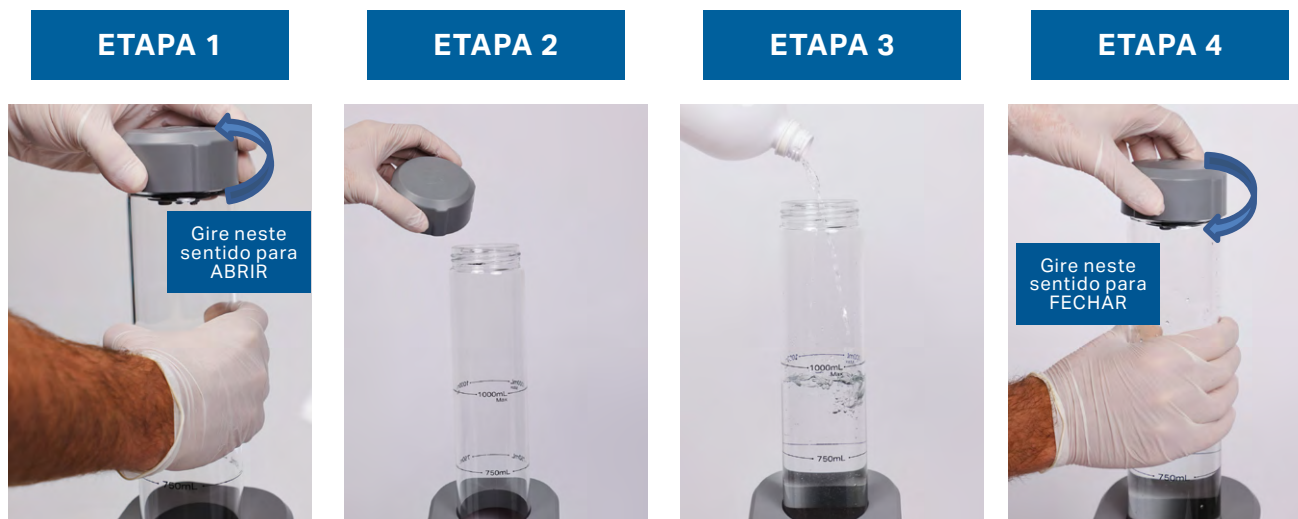
Figura 3 - Abastecimento da Torre com Água Bidestilada
