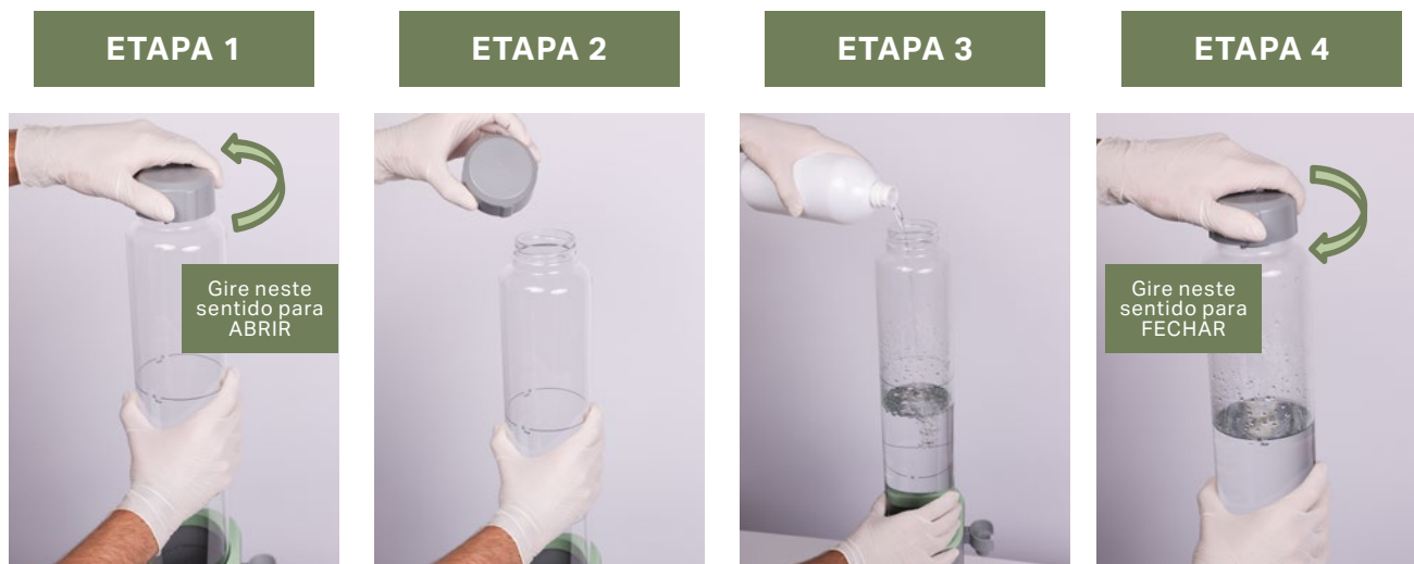
Figura 3 - Abastecimento da Torre com Água Bidestilada
