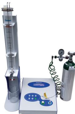
**Figura 7 - Montagem do conjunto para ozonização de água**
