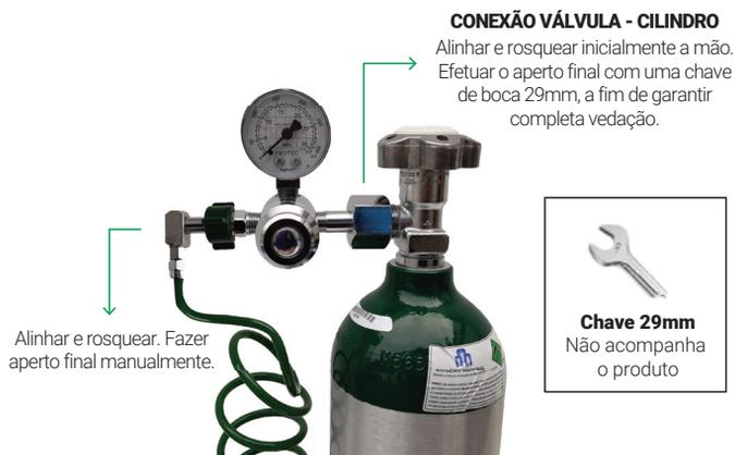
**Figura 8 – Conexão da válvula no cilindro de Oxigênio**
