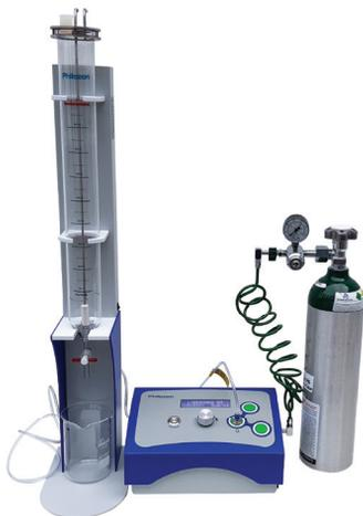
Figura 14 – Montagem do conjunto para ozonização de água
