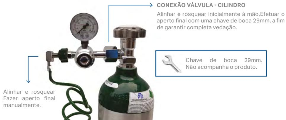
**Figura 7 - Conexão da válvula no cilindro de oxigênio**
