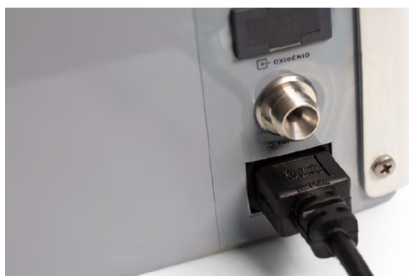
FIGURA 9 - CONEXÃO DO CABO DE FORÇA
