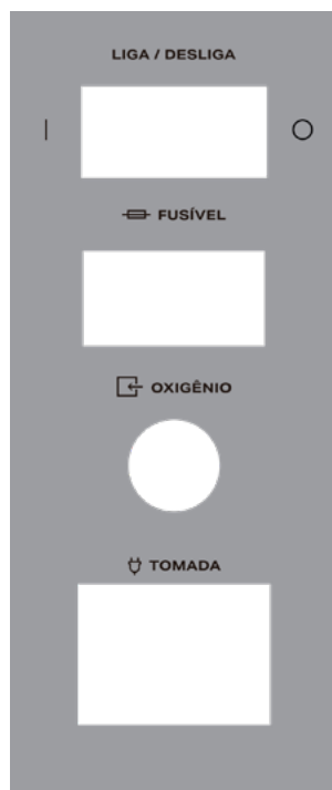
FIGURA 19 - INDICAÇÕES DAS CONEXÕES TRASEIRAS DO GERADOR
