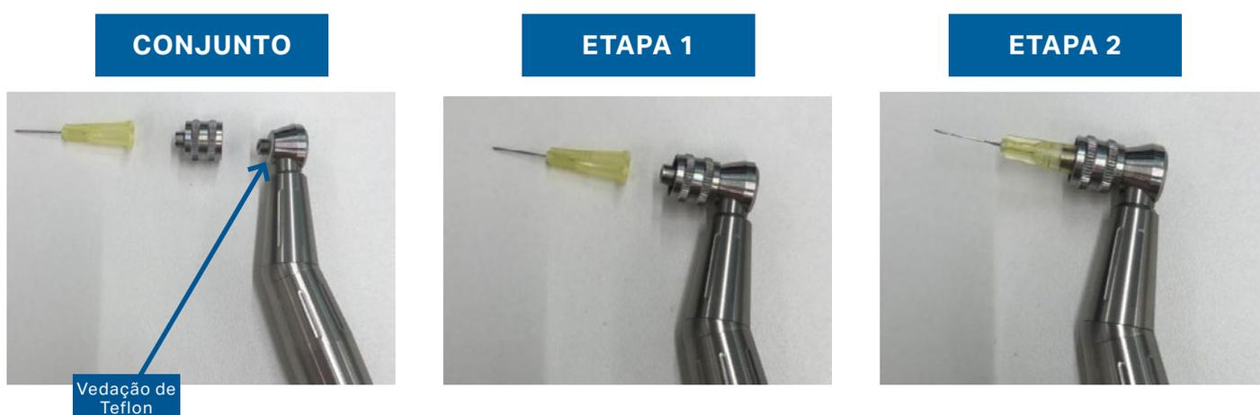
**Figura 6 - Etapas para conexão da agulha**
