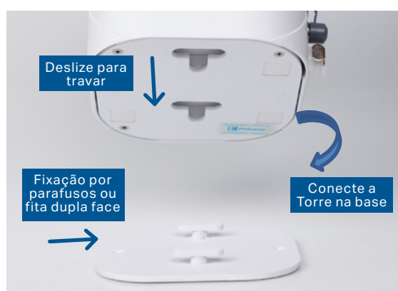
Figura 2 - Encaixe da base da Torre
