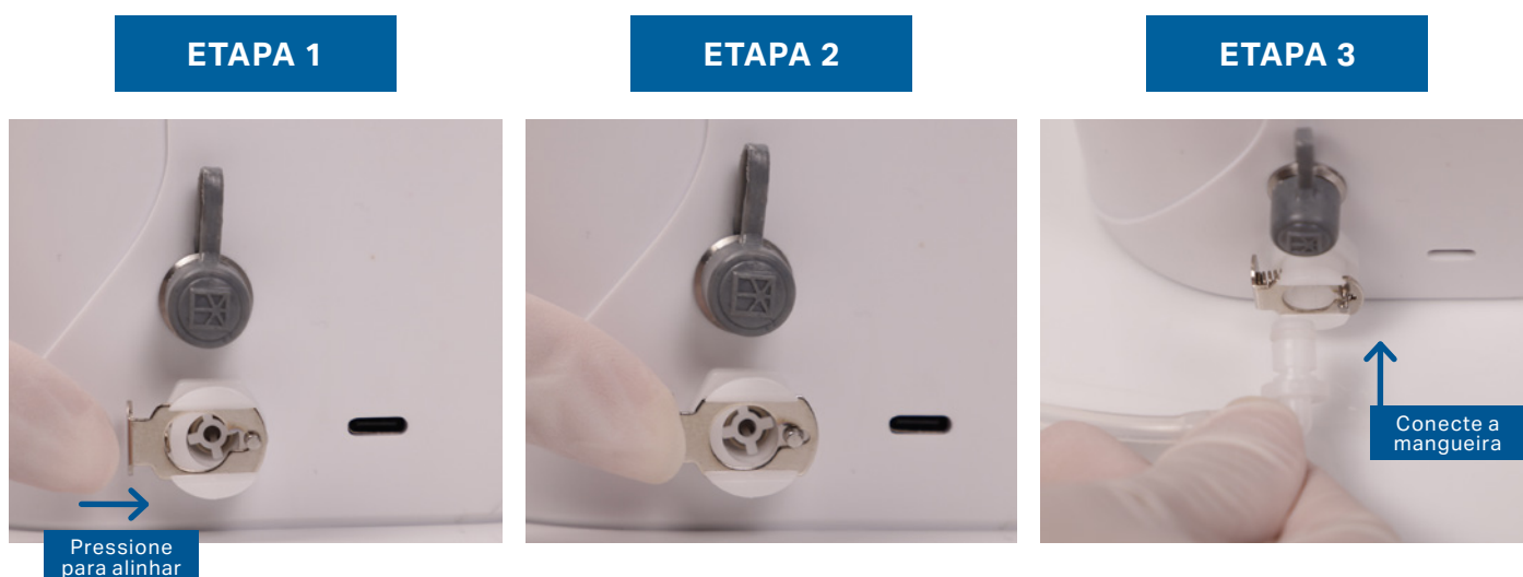
Figura 9 - Instalação do adaptador da saída lateral
