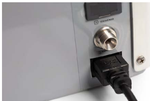
Figura 9 - Conexão do cabo de força
