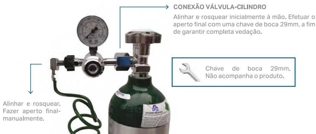
Figura 7 - Conexão da Válvula no Cilindro de Oxigênio
