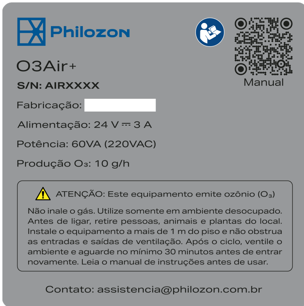
Figura 15 - Etiqueta indelével com número de série e informações técnicas
