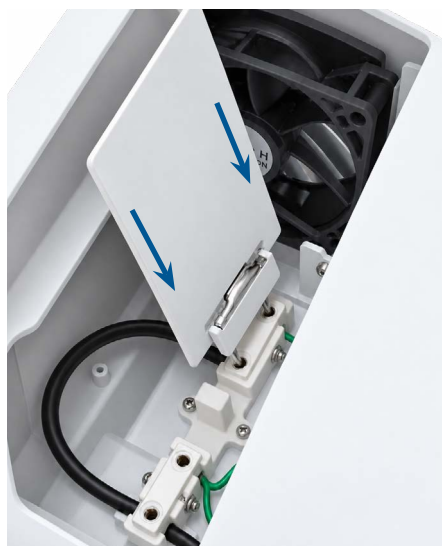
Figura 14 - Instalação das células geradoras
